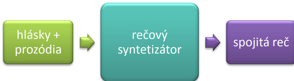
Obrázok 1 Bloková schéma rečového syntetizátora.
