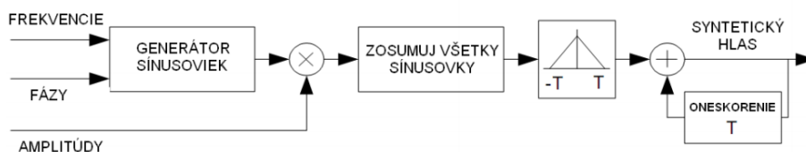
Obr. 4: Princíp syntézy signálu v sínusovom modeli [13]
